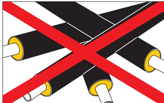
Wie aus der Abbildung ersichtlich die Rohre auf einer ebenen Unterlage aus steinlosem Sand mit Sandbänken mit einer Mindestbreite von 0,5 m stapeln.
