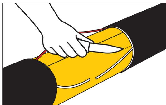
Einen Schlitz in die Dämmschalen machen, damit der Überwachungsdraht die Diffusionssperre, D, unter dem Mantelrohr nicht berührt.
